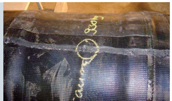
BILD 4: DIRAX-System, Ergebnis nach 930 kg Belastung durch scharfkantigen Stein
