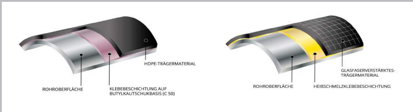
Bild 4: Aufbau der Nachumhüllungsmaterialien „WPC“ (links) und „CLMP-F“ (rechts)
