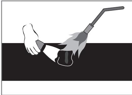
**2.** Füller in Größe der Beschädigung ablängen. Schadstelle vorwärmen bis +60 °C, den Füller auflegen, erwärmen und mit einem heißen Spachtel glätten.
